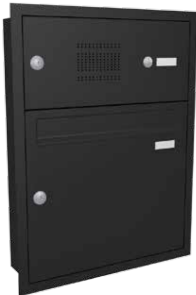
Briefkastenanlage BKA Fuka-165 anthrazit DB 703 Mit Klingel und Vorbereitung für Sprechanlage Rahmen und Klappe Aluminium pulverbeschichtet Anthrazit DB 703 Gehäuse und Tür Stahlblech verzinkt Maße außen: 41,2 x 53,8 cm Maße Kasten: 37 x 49,6 x 10 cm Maße Briefschlitz: 32,5 x 3,5 cm
