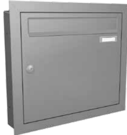
Briefkasten UP10-110 Edelstahl V2A Rahmen, Klappe und Tür Edelstahl Gehäuse Stahlblech verzinkt Maße außen: 43,2 x 39,2 cm Maße Kasten: 37 x 33 x 10 cm Maße Briefschlitz: 32,5 x 3,5 cm
