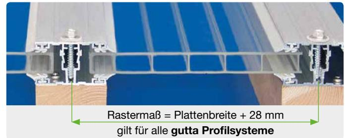
**Die Verlegesysteme sind nicht selbsttragend und erfordern auf jeden Fall eine Unterkonstruktion!**
