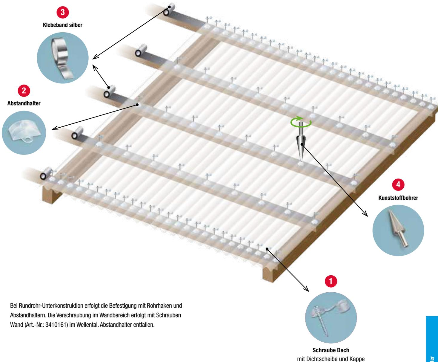
Bei Rundrohr-Unterkonstruktion erfolgt die Befestigung mit Rohrhaken und Abstandhaltern. Die Verschraubung im Wandbereich erfolgt mit Schrauben Wand (Art.-Nr.: 3410161) im Wellental. Abstandhalter entfallen.
