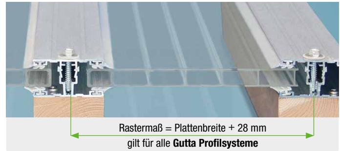
**Die Verlegesysteme sind nicht selbsttragend und erfordern auf jeden Fall eine Unterkonstruktion!**
